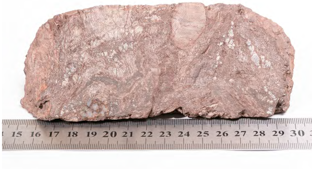
Abbildung 12-6. Binderberg 1, Kern 8 (1696 - 1701m): Kataklastisches Störungzonengestein.
