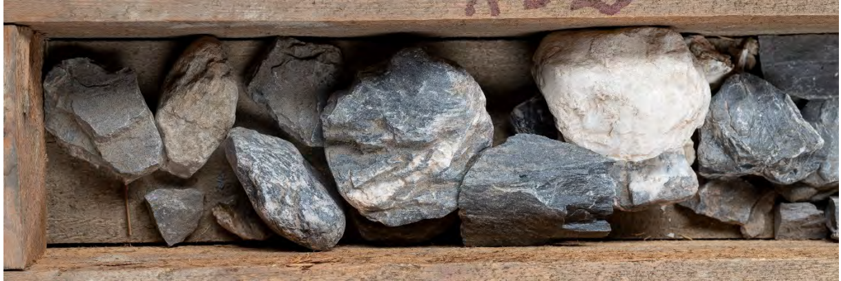
Abbildung 12-16. Übersbach 1, Kern von 2666 - 2692 m: Kalkstein; teilweise mit feiner Bänderung. Das weiße Bruchstück ist eine calcitische Klufffüllung.
