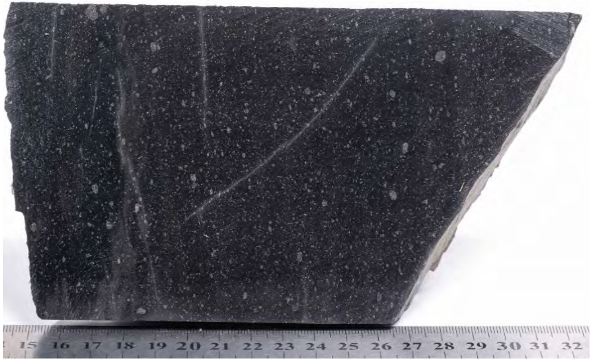
Abbildung 6-6. Miozäner Tuffit bzw. Ignimbrit der Bohrung Petersdorf 1 aus einer Tiefe von ca. 3.030 m.
