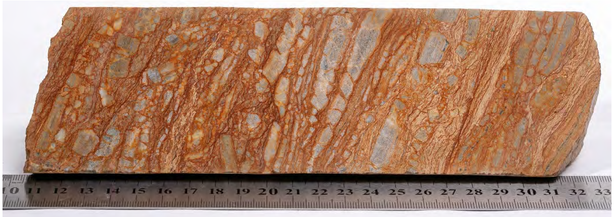
Abbildung 12-9. Blumau 1a, Kern 9 (2752 - 2757 m): „Dolomit mit Tonschieferlagen“ (Beschreibung nach Bohrprofil)
