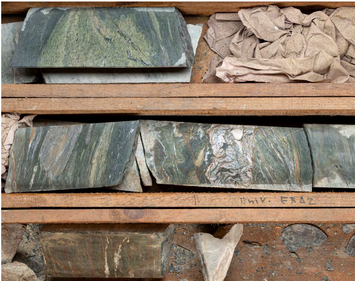
Abbildung 6-8. Paläozoischer Grünschiefer der Bohrung Blumau 1 aus ca. 1.850 m Tiefe
