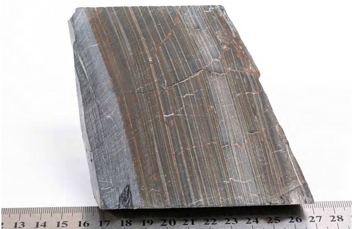
Abbildung 12-2. Arnwiesen 1, Kern 6 (448 - 466 m): Karbonatische Tonschiefer. Möglicherweise Hahngraben Formation („Schiefer der Dult“, OD) oder Schönberg Formation (UD).
