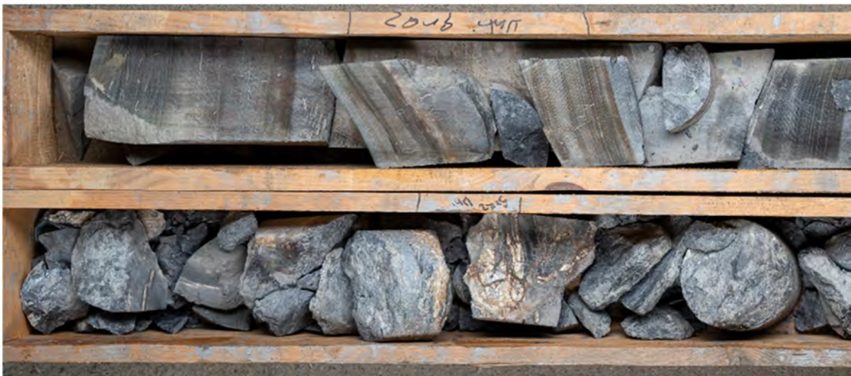
Abbildung 6-3. Paläozoische Tonschiefer der Bohrung Arnwiesen 1 aus einer Tiefe zwischen 448 und 466 m.
