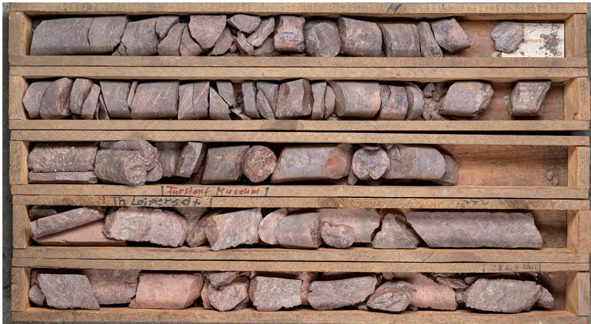
Abbildung 12-5. Binderberg 1, Kern 8 (1696 - 1701m), Kiste 1 bis 5: Kataklastisches Störungzonengestein sowie Phyllit
