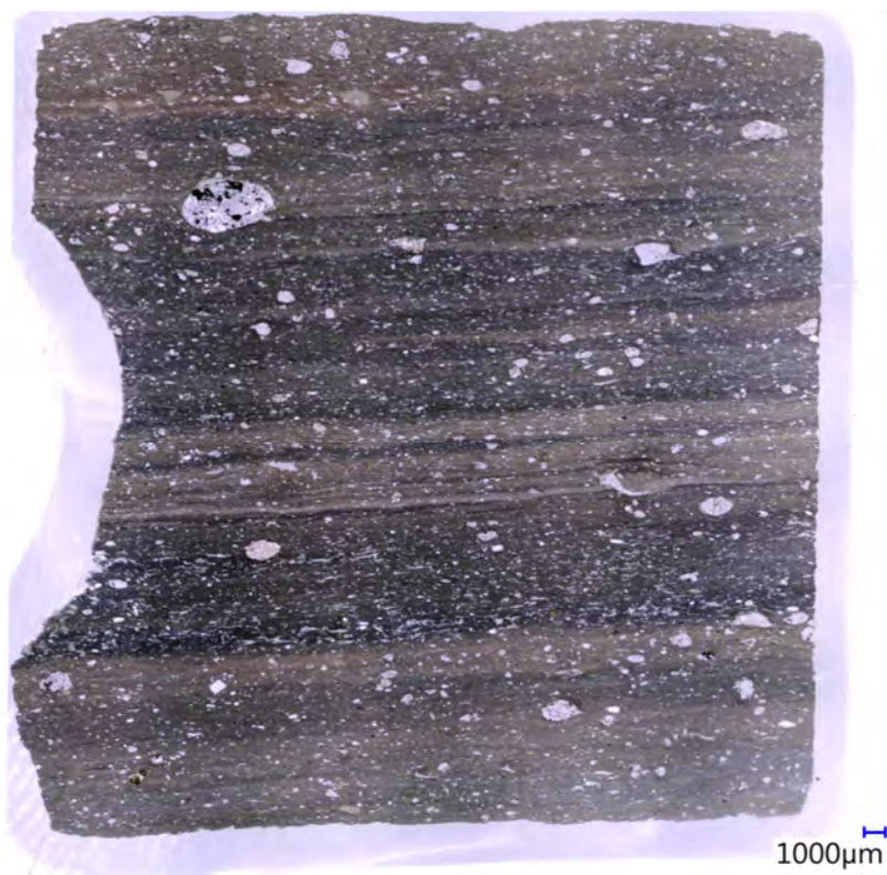
Abbildung 6-7. Dünnschliff des Miozänen Tuffit/Ignimbrit der Bohrung Petersdorf 1 aus ca. 3.030 m Tiefe.
