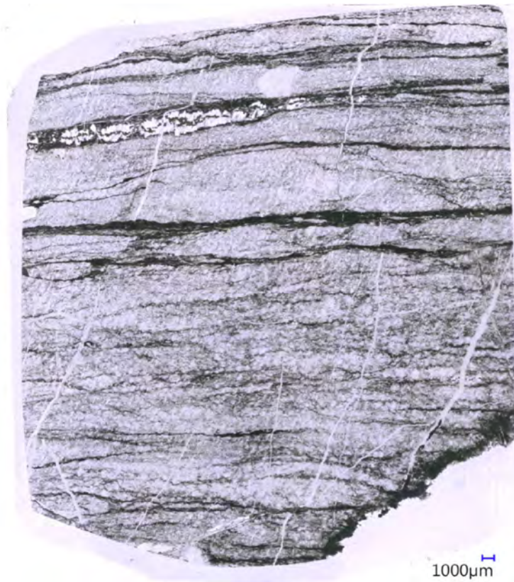
Abbildung 12-18. Dünnschliff eines paläozoischen Dolomitschiefer aus der Bohrung Übersbach 1.
